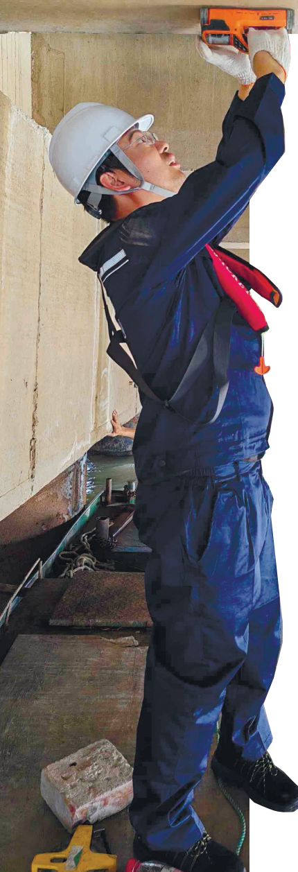
工作人员在码头下方测试钢筋混凝土中的钢筋分布和保护层厚度。
