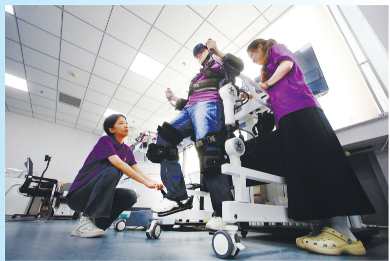
脑控下肢外骨骼康复系统测试中,脑机接口技术与下肢外骨骼机器人深度融合,通过采集并解码人脑运动意图信号,实现“意念”驱动的外骨骼控制,帮助患者加速康复进程。
