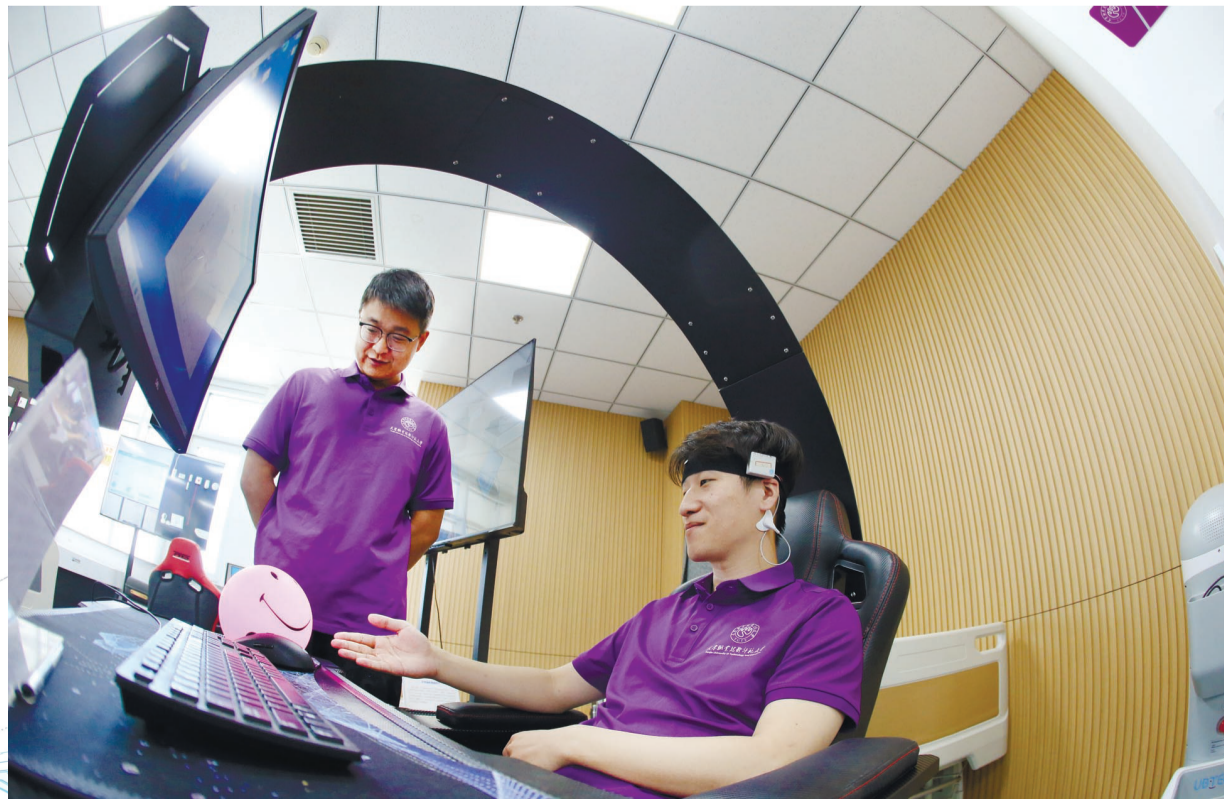
音乐心理座舱,以脑机接口技术为核心,结合音乐和经颅电刺激辅助疗法,以交互式心理评估与减压座舱为载体,通过监测用户的脑电波来调节音乐的节奏,并辅以个性化电刺激干预,从而有效舒缓压力、调节情绪并提升睡眠质量等。
