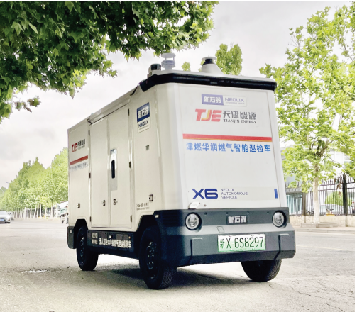
我市首辆PPB级(目标检测气体占整个气体系积十亿分之一)无人驾驶燃气泄漏检测车日前在天津能源集团投用。图为该车在青西景区紫阳道巡检。 记者 张磊 摄
