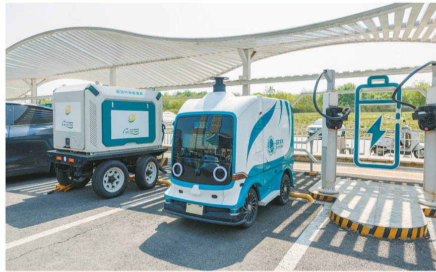
日前,泰达城发集团引进的移动储能充电机器人在经开区试点投用。机器人可全向移动、自主寻位,实现“桩找车”即停即充。 记者 赵建伟 摄
