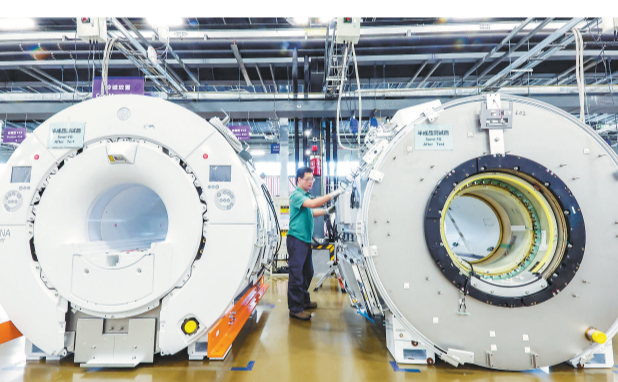
GE医疗天津基地内，工作人员对磁共振设备进行组装。 记者 吴迪 摄
