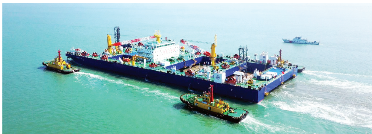
中交一航局自主研发建造的世界首制沉管运输安装一体船“一航津安1”开展深中通道沉管隧道浮运安装作业。照片由受访者单位提供
