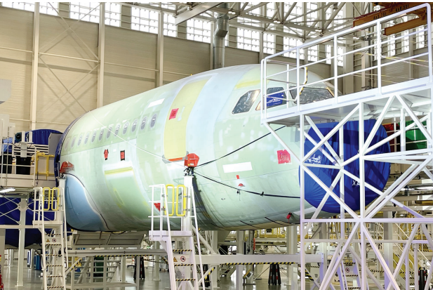
空客天津A320系列飞机第二条总装线。
