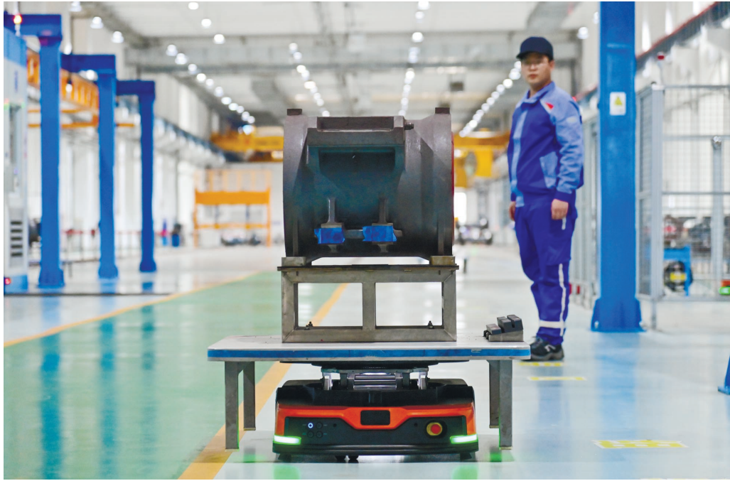
智能AGV运输机器人代替原有人工叉车牵引电机搬运。
