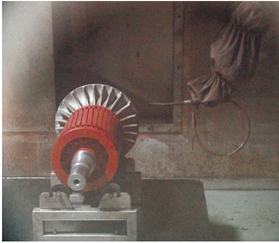
智能化电机流水产线正在开展牵引电机转子全自动吹扫工作,相比传统人工吹扫既避免了污染,产品清洁度也得到了提升。
