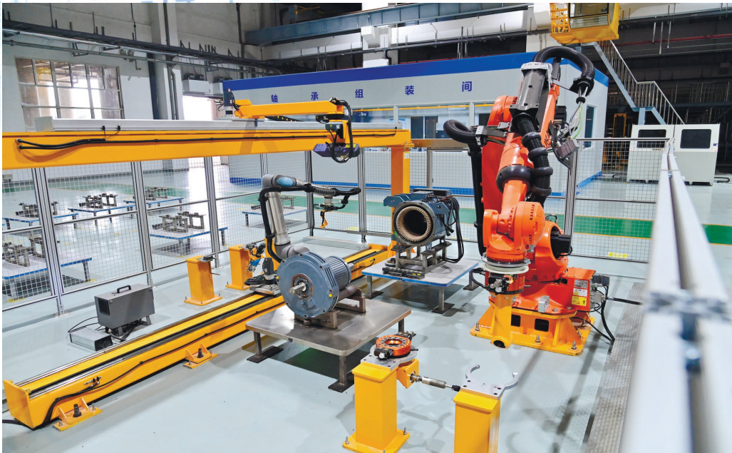
智能机械臂自动进行牵引电机组装作业,比人工操作更精准、高效。
