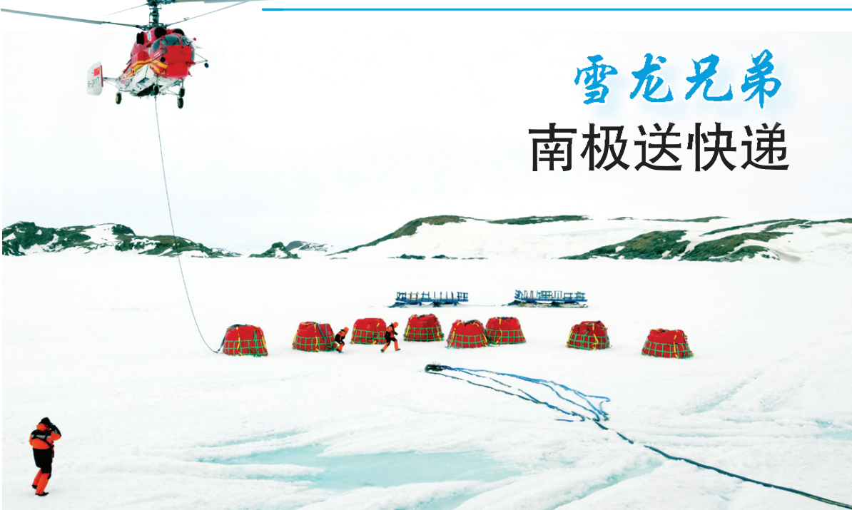
北京时间12月2日傍晚,“雪鹰102”直升机从“雪龙”号甲板飞至“雪龙2”号船侧冰面作业点,开启油囊吊装作业。 新华社发
