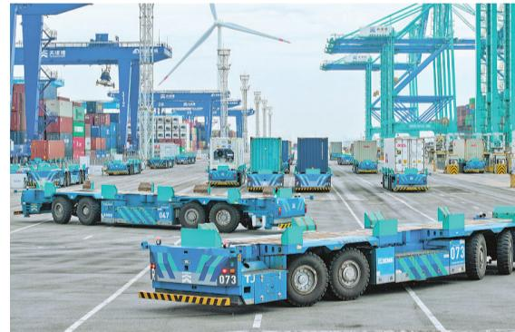
智能水平运输机器人行驶在天津港第二集装箱码头。
