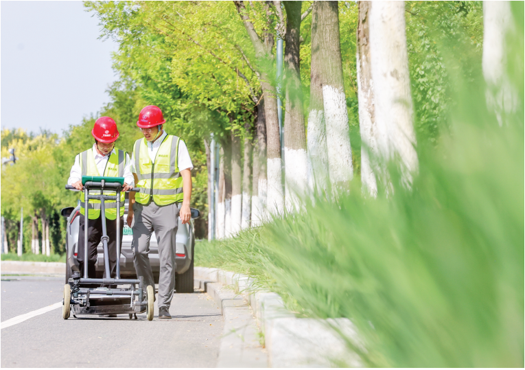
利用手推式探地雷达对道路进行检测。
