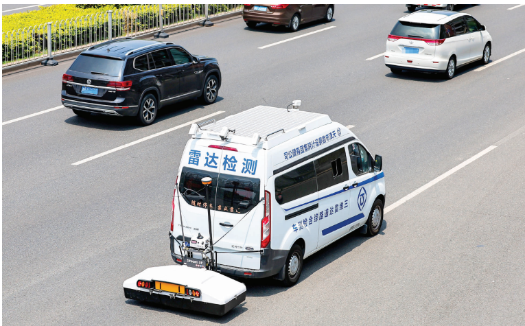
三维雷达道路综合检测车在道路上进行巡检。
