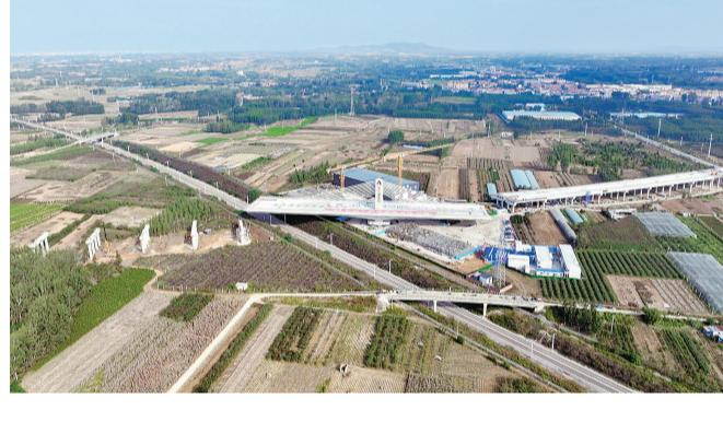
10月21日，由山东高速集团投资、中铁十四局承建的山东董梁高速上跨瓦日铁路立交桥顺利完成转体施工。这座重达2.5万吨的转体桥位于山东省临沂市，采用抗滑拉索体系，实现精准对接。
