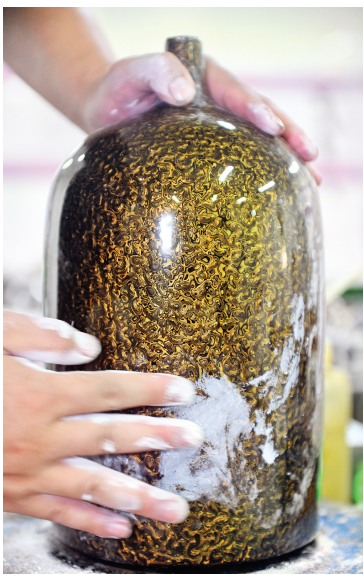
◀手工推光。在用砂纸打磨数十遍后,还需使用推光粉用手打磨,才能达到光滑如镜的效果。
