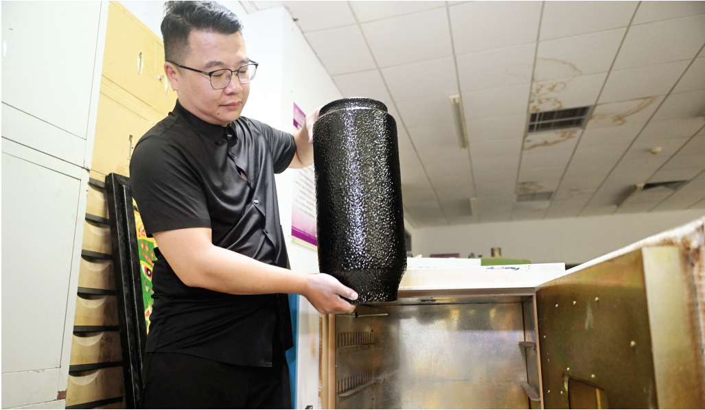
漆器需要一遍遍上漆,干燥,打磨,为了缩短教学过程,郑勇使用电子设备加温干燥。
