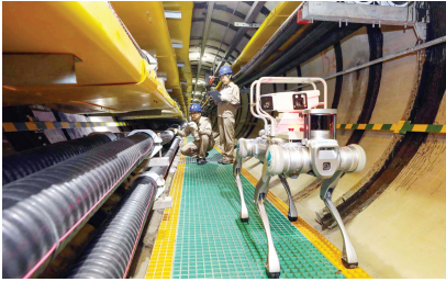
智能巡检机器人校正沿预设路线巡检。
