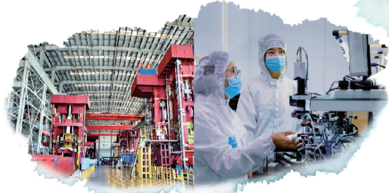
左图 天津市天锻压力机有限公司厂房。 右图 宜科自动化编码器高精度产品无尘车间,工作人员正在为新品进行码盘校准试验。
