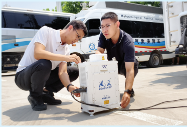
天津气象雷达研究试验中心业务人员调试测风激光雷达。 通讯员 张妍 杨莹 肖涵 姜明 摄
