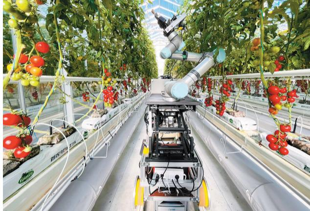
8月11日,全球首台全流程智能育种机器人“吉儿”(GEAIR)登上国际学术期刊《细胞》杂志。“吉尔”由中国科学院遗传与发育生物学研究所和自动化研究所科研团队合作研制,能够精准识别花朵、伸出机械臂轻柔完成杂交授粉,代替工人完成全流程育种工作。图为智能育种机器人“吉儿”在位于北京的一个现代化商业温室中进行番茄自动杂交授粉操作。
