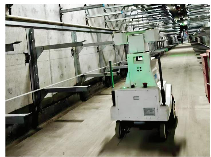
中国一冶利用巡检机器人在北辰区地下综合管廊内进行巡检。地下综合管廊和巡检机器人的投用,有效避免了工作人员冒高温进行户外作业,同时也大大提升了管线的安全性。
