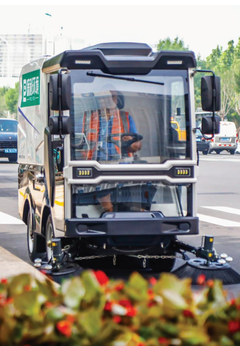
河西区环境卫生作业单位保利公司新增配小型新能源湿式扫路机,内置空调,同时具备强力吸扫、外部管吸和洗路喷洒三种功能,在安全、高效、环保的同时大大减轻了保洁人员的工作量。
