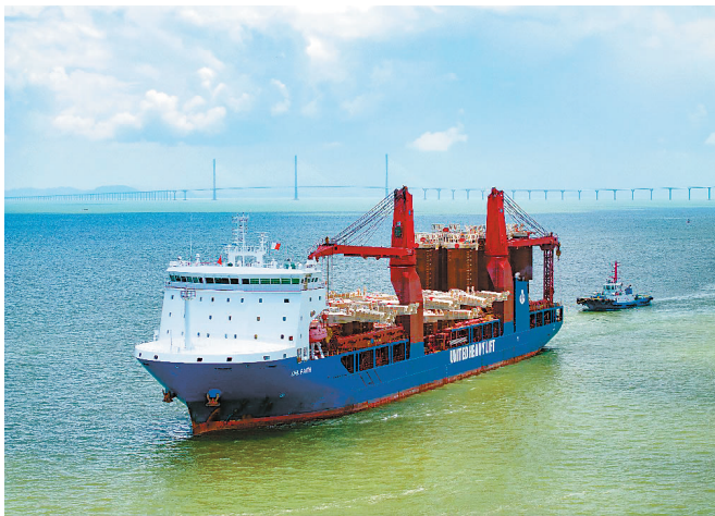
图为运输船装载24套2000米级国际超深水吸力锚起航运往巴西梅罗油田。 海油工程供图
