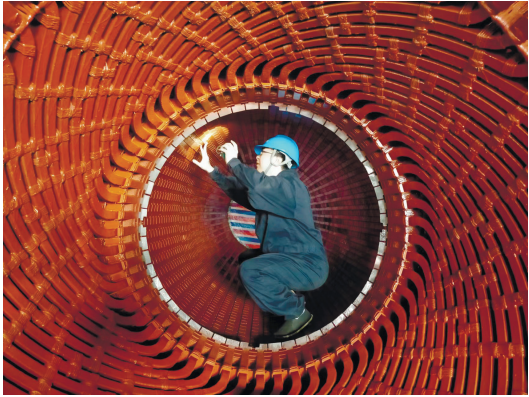
陈塘热电生产技术部工作人员正在发电机的定子膛内进行检查。
