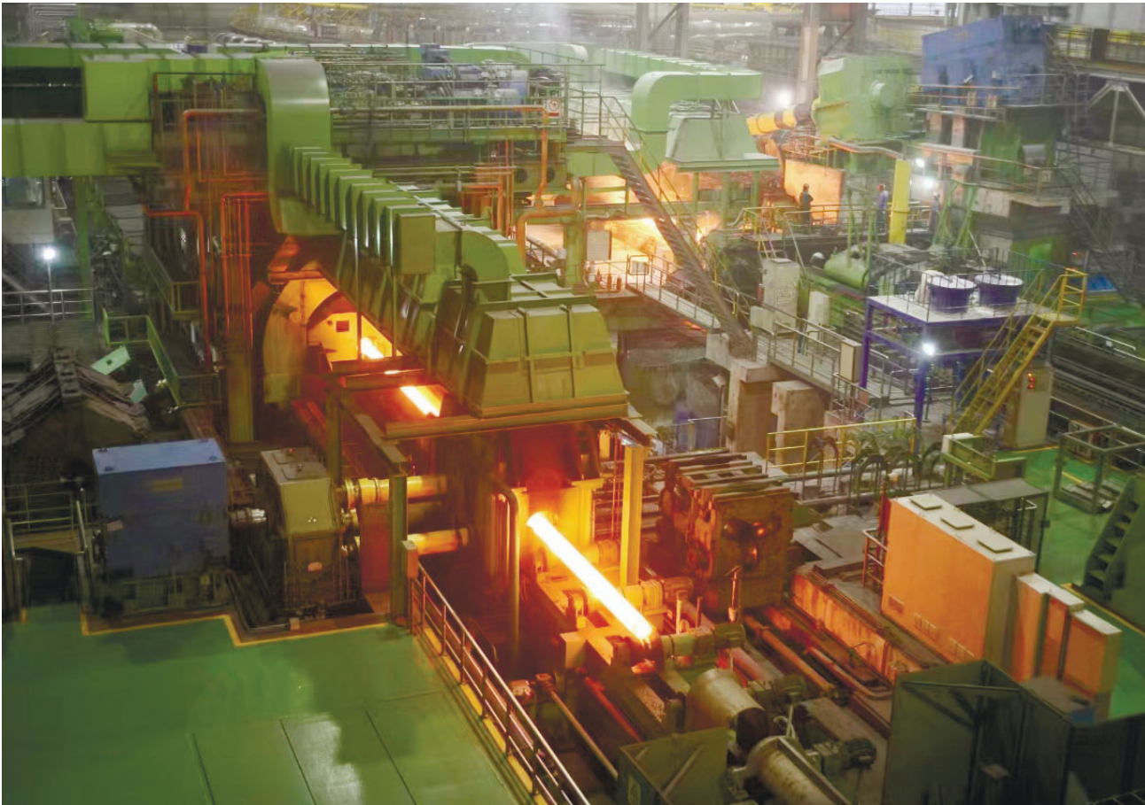
天津钢管460机组大口径三辊连轧生产线。
