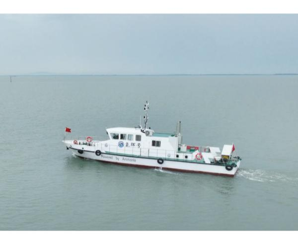
6月28日,全球首艘纯氢燃料内燃机动力示范船舶“氢晖号”在安徽合肥巢湖水域首航成功。这标志着氢燃料在船舶领域的工业化应用取得重大突破,为航运业节能减排、绿色发展开辟了一条切实可行的新路径。
