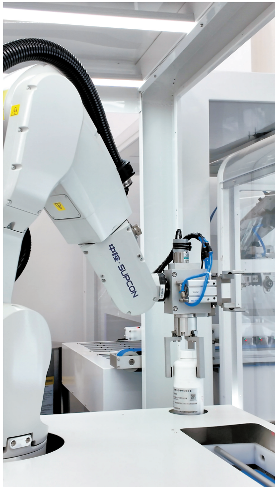
机械臂可精准处理工业循环水样品,完成旋盖、量取、检测等精细动作。
