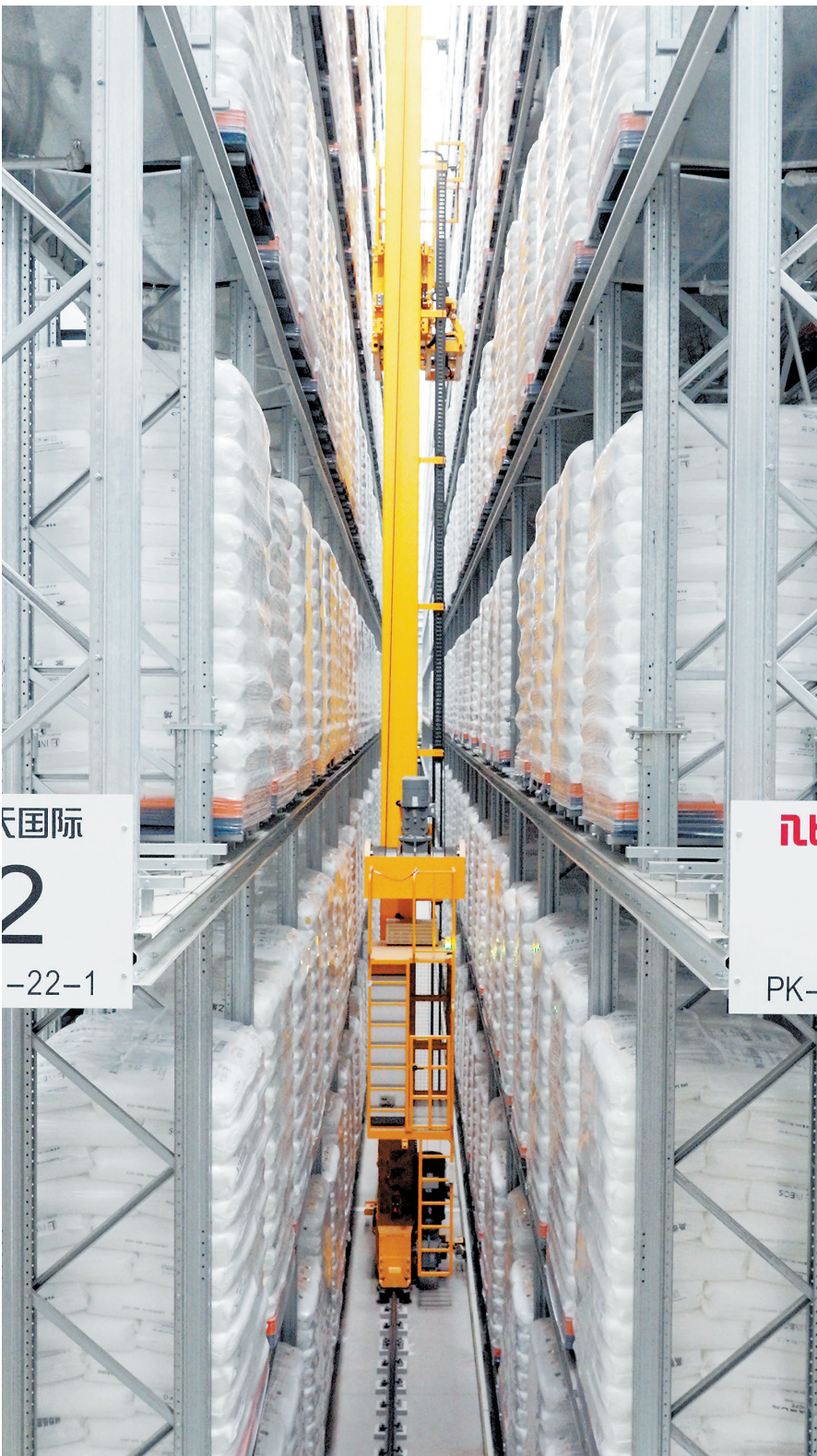
智能化立体仓库采用巷道堆垛机,在高层货架间自行存取货物。
