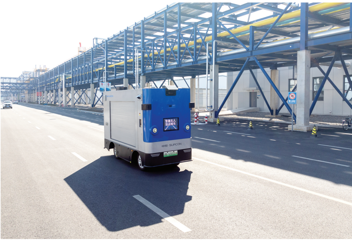
智能无人取送样车穿梭于厂区内,工作范围覆盖多个站点装置区。
