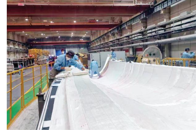
针对不同规格的风电叶片,从叶尖到叶根,工作人员少则铺十几层玻璃纤维布,多则铺上百层玻璃纤维布。
