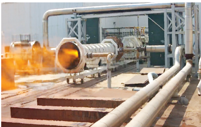
图为YF-75D氢氧发动机高空模拟试验。
