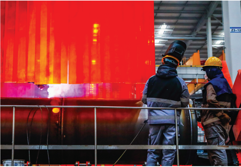
欧尚元智能装备有限公司定位于合成生物技术等工艺总设计与核心智能装备研发的生产制造,企业积极与高校科研院所对接合作,潜心研发自动化与发酵提纯等工艺控制设备。图为双联柱正在进行机械手焊接和开孔。
