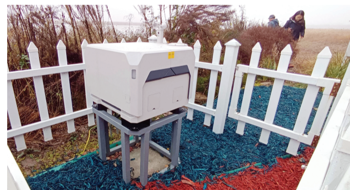
七里海湿地内的无人机巡检设备。
