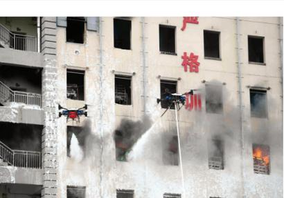
测试现场,灭火无人机进行高层灭火作业。图片由市消防救援总队提供
