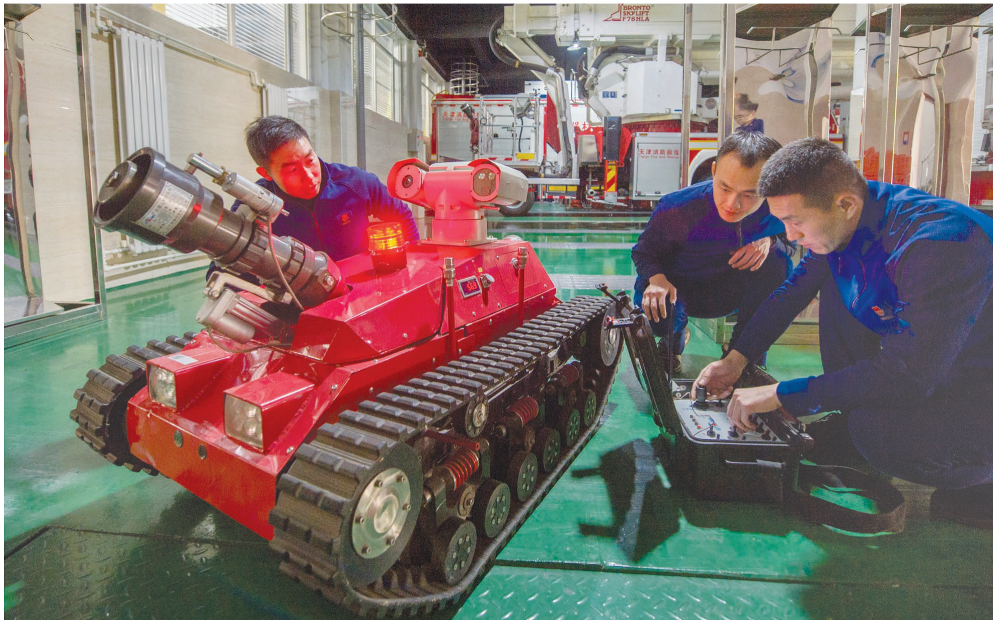
履带式灭火机器人能够在建筑物倒塌、地面复杂的环境中作业,具有机动性强、喷射流量大、射程远等优点,成为现代化消防工作中不可或缺的助手。
