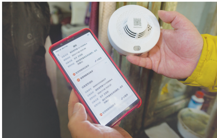
单点报警设备接入物联网系统,一旦家中出现浓烟,社区网格员手机会自动报警,及时处理险情。
