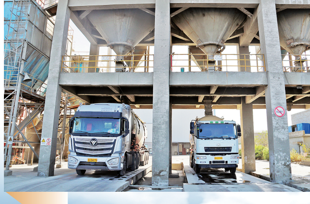
新疆雁池科技发展有限公司的水泥罐车在装载水泥。何玉莲 摄
