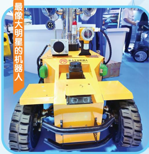
河北展区通今工业机器人(河北)有限公司的LNG智能巡检机器人，它的功能是检测天然气泄漏、罐区温度异常。它长得很像动画片《机器人总动员》里的大明星——“瓦力”。
