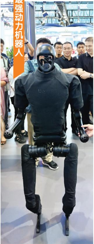
宇树H1机器人是全球近似规格动力最强的通用型人形机器人，走路的速度和平衡能力最强，推不倒、踉跄不倒，双臂托举负重30公斤以内。
