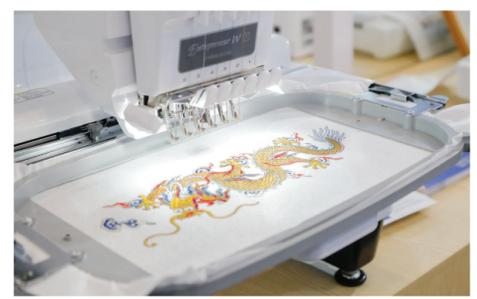
▲ 智能绣花机器人通过激光定位,机械手自主操控,可以绣出形态各异的图案。
