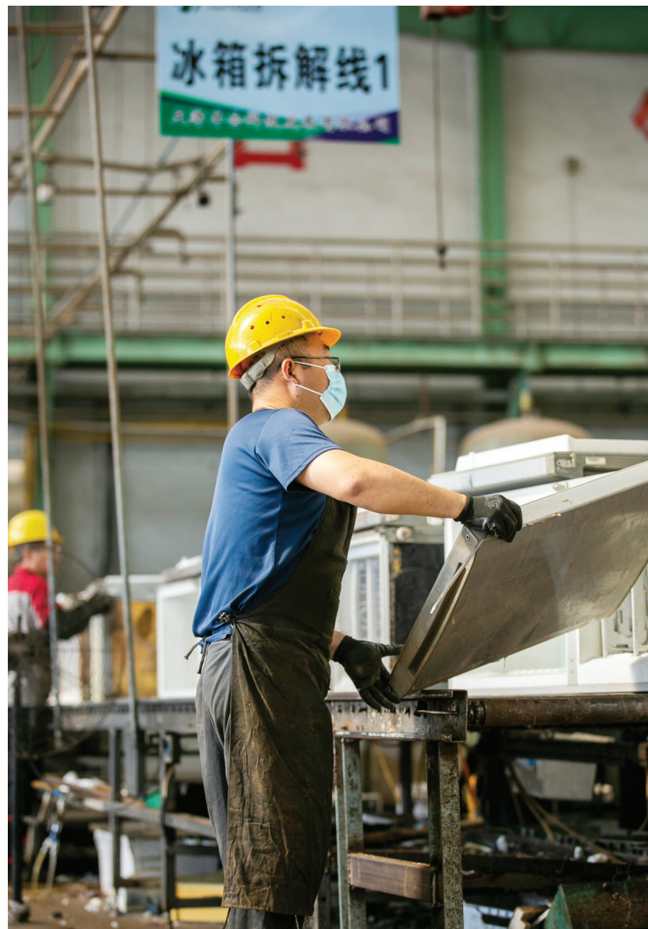
以冰箱拆解线为例,目前除冷媒回收和压缩机预处理需人工操作外,后端箱体破碎、物料分选均已实现自动化。
