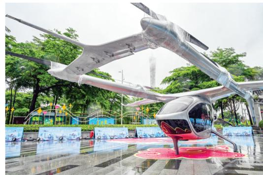
近日,一场低空航展在广州天德广场举行,10余架明星eVTOL(电动垂直起降飞行器)机型集中亮相,进行静态展示。图为大型eVTOL载人航空器盛世龙,该机5座设计,最大起飞重量2吨,速度可超200公里/小时。
