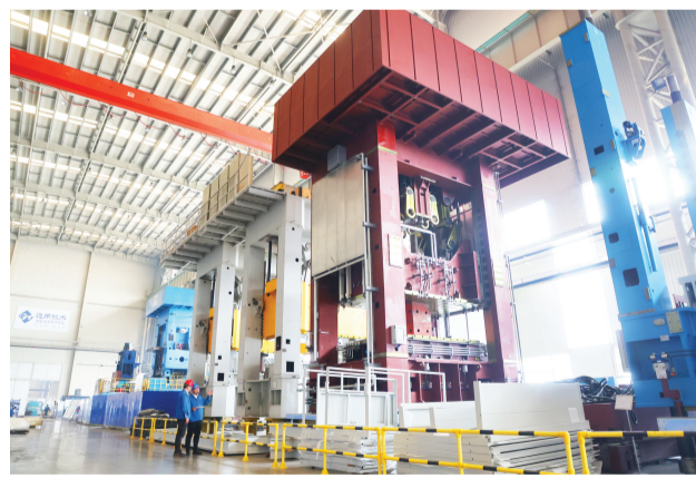
通用技术天锻公司生产车间12000kN(千牛)复合驱动热成型压机。
