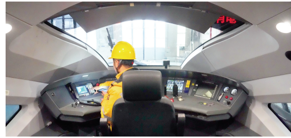
2月28日,在上海虹桥动车运用所,电务段工作人员在司机室内检查无线通信设备,守护旅客出行安全。新华社发
