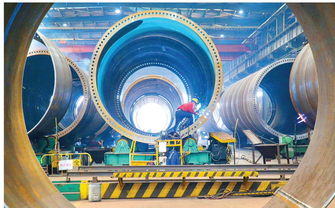
在生产风电塔架。江苏连云港经济技术开发区一家风电设备公司车间内，工人 新华社发
