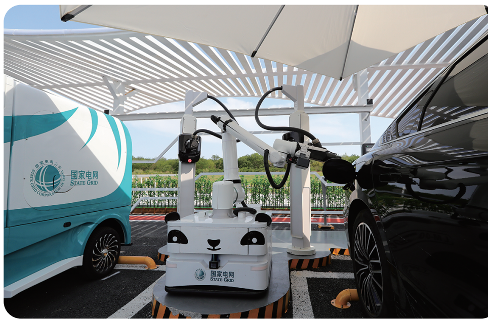
▲国网天津电力滨海于家堡双碳创新充电站内自动充电机器人新能源车充电。
