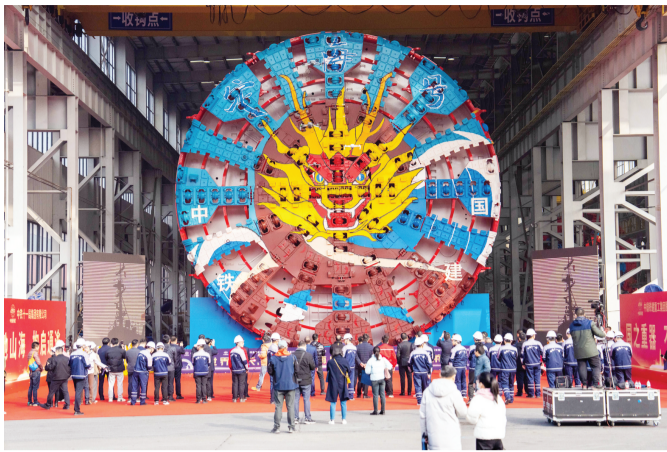
昨日,超大直径盾构机“定海号”在铁建重工长沙第一产业园下线。其最大开挖直径14.57米,总重量达4350吨,将投用于世界最长的海底高铁隧道——甬舟铁路金塘海底隧道建设。新华社发
