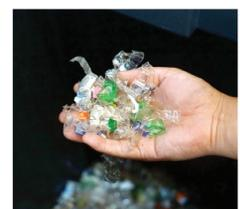
►废弃塑料瓶经过破碎减量后得到的塑料片。
