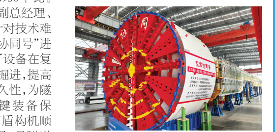
“京滨协同号”盾构机。中铁十四局供图
