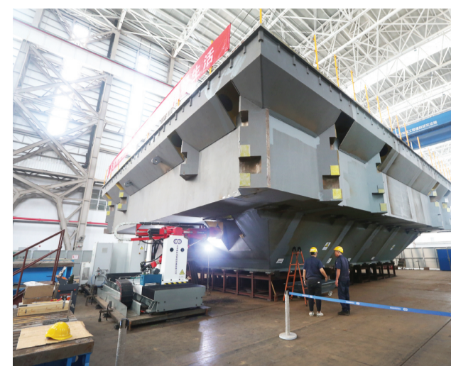
技术人员正在用可移动数控铣床为大型地震模拟振动台底部安装装置。 本报记者 姜宝成 摄
