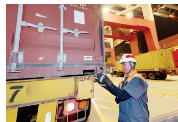
▲赵建新对集装箱扭锁进行拆装。 ▼赵建新现场指挥着拖车。
