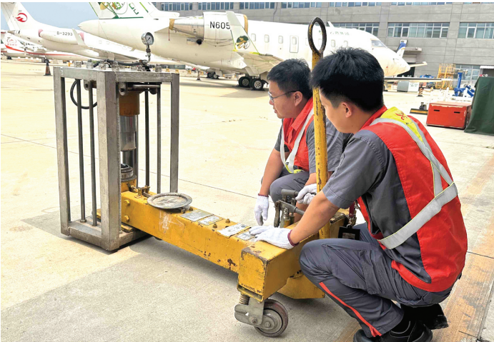
机务人员用自主研发的飞机轮轴千斤顶测试台进行维修保障工作。 海航技术(天津)供图
