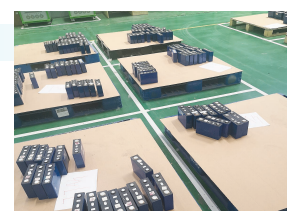
已分容电芯缓存区。
