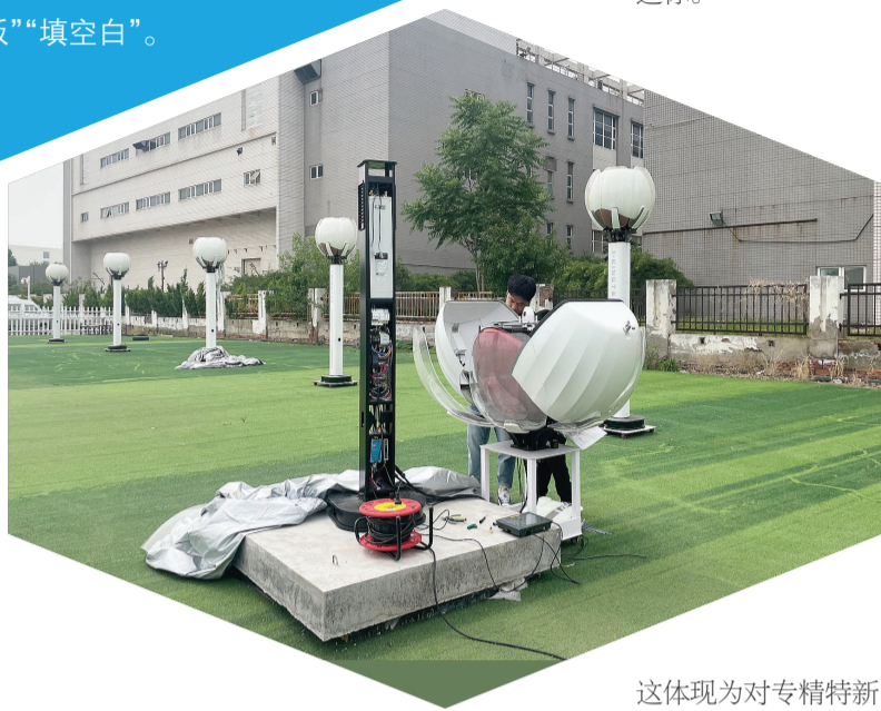
云圣智能“宝莲灯全自动无人机机场”组装测试。
