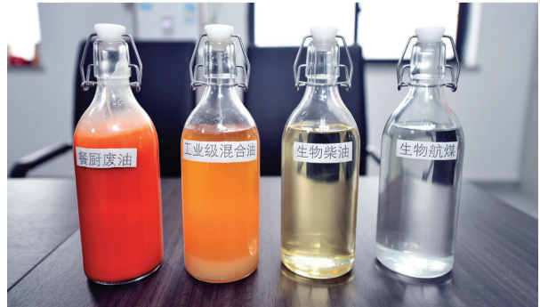
图为四川一家环保科技有限公司展示的餐厨废油、工业级混合油、生物柴油和生物航空煤油样品。 新华社发
