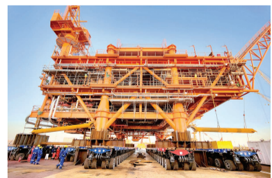
图为装载近1900吨垦利6-1项目WHPF组块的SPMT小车抵达海油工程天津智能化制造基地设计位置,进行装船作业。 受访者供图
